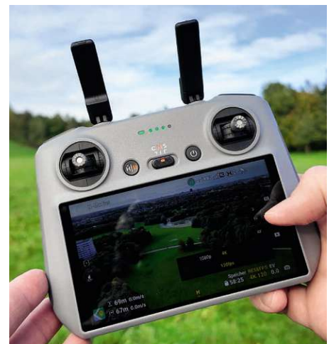
RC-2 mit eingebautem Display Die Fernbedienung RC-2 ist im Kit DJI Air 3S Fly More Combo erhältlich. Die RC-N3 im Standard-Kit benötigt ein Handy als Display.
