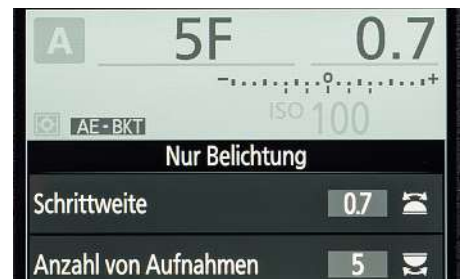
Hell nach dunkel: Die „Bracketing“-Funktion fertigt automatisch Belichtungsreihen an. Hier eine fünfteilige Serie in Schritten von 0,7 Blendenstufen.
